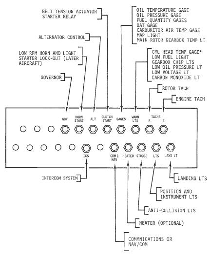
\*ON GAGES CIRCUIT BREAKER PRIOR TO SHIP S/N 656.
